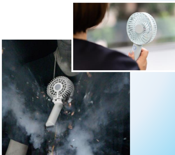
ハンディファンのリチウムイオンバッテリー の破裂：NITEの公開映像より
